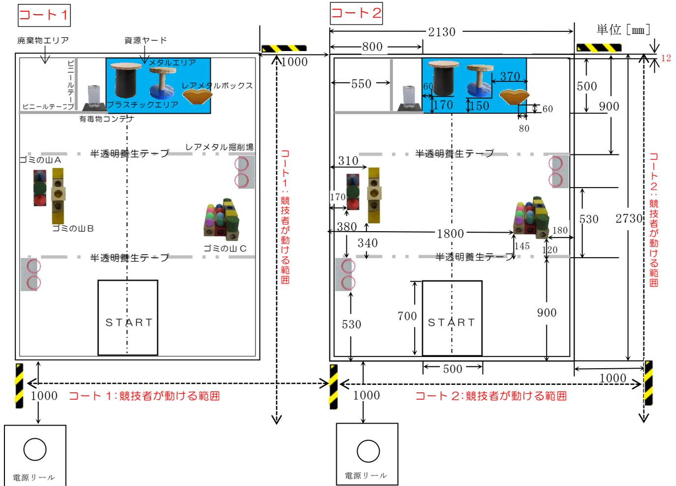
1. 競技台は、縦 2730 mm、横 2130 mm、厚さ 3 mm のベニヤ板製で、周囲は幅 12 mm、高さ 12 mm の木製の角材で囲まれている。
