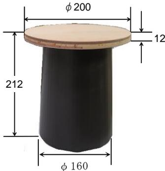
「直径 20cm、厚さ 12mm の木製円板」と「直径 16 cm、高さ 20cm のプラスチック製ごみ箱」の底の間に「スプーサー用の木の板」を挟み「両面テープ」(裏表ともに両面テープを貼る)で貼り付けて固定しています。
