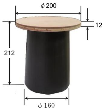
「直径 20cm、厚さ 12mm の木製円板」と「直径 16 cm、高さ 20cm のプラスチック製ごみ箱」の底の間に「スペーサー用の木の板」を挟み「両面テープ」(裏表ともに両面テープを貼る)で貼り付けて固定しています。
