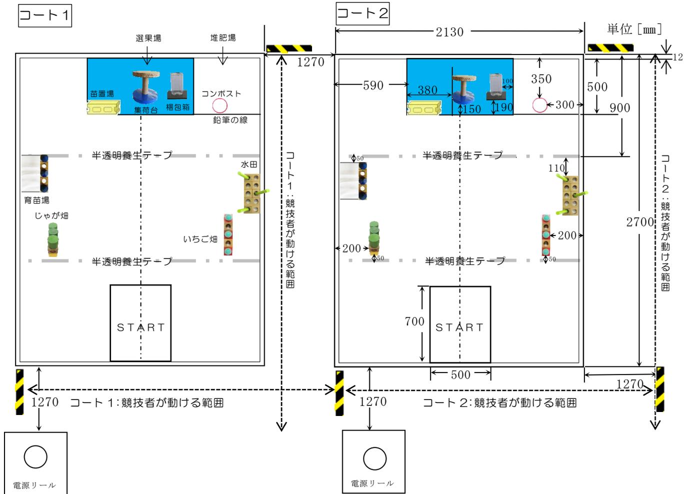
1. 競技台は、縦 2700 mm、横 2130 mm、厚さ 3 mm のベニヤ板製で、周囲は幅 12 mm、高さ 12 mm の木製の角材で囲まれている。
