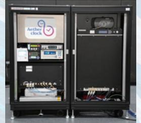
▲開発した小型光格子時計。レーザー冷却された原子を光格子中に捕獲し、低温に冷却した恒温槽の中で時計遷移を高精度に分光する。
